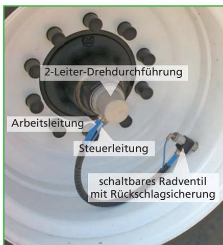
Das System wird mit einem Sicherheitsventil an die Druckluftbremsanlage angeschlossen, so daß stets 6,5 bar Vorratsdruck garantiert sind.
