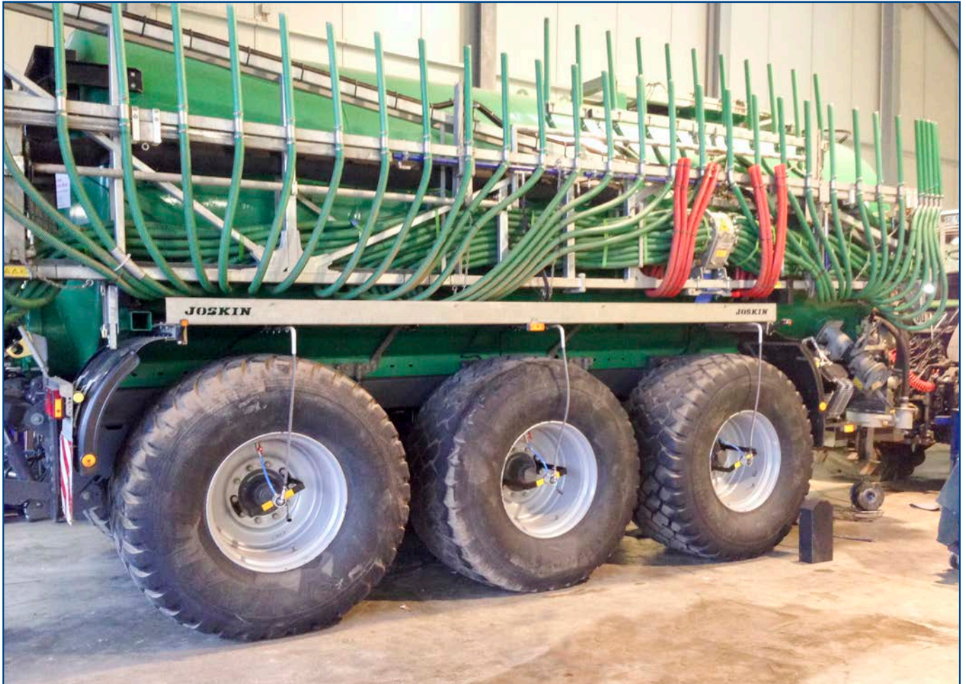
AIRBOX/drive 1L mit Pneumatik-Steuerung 1-Leiter-Reifendruckregelsystem für Güllewagen & Anhänger
