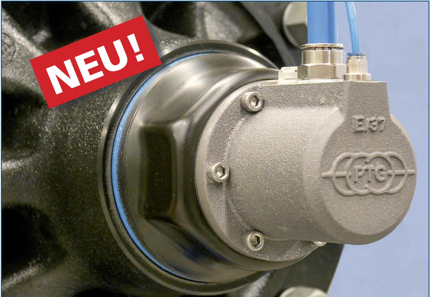
Drehdurchführung mit Fettkappe verschraubt – kein Eindringen von Staub und Wasser
