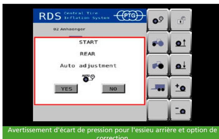
Avertissement d'écart de pression pour l'essieu arrière et option de correction
