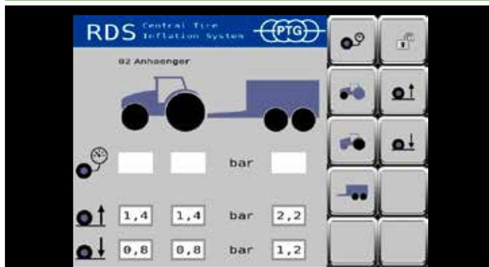
Pantalla de trabajo antes de la medición de la presión de los neumáticos
