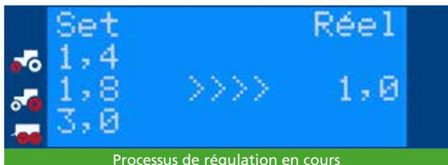
La pression de consigne des pneus sélectionnée est affichée à côté du symbole correspondant, situé sur le bord gauche de l'écran. Les (quatre) flèches vers la droite indiquent le processus de régulation actif.
