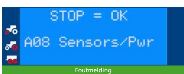
Om na het verhelpen van de fout het bandendrukwissel-systeem weer volledig te kunnen gebruiken, moet wor-den uit- en ingeschakeld. Voor het verhelpen van de fout moet de bedieningsconsole met de tuimelschakelaar wor-den uit- en weer ingeschakeld.
