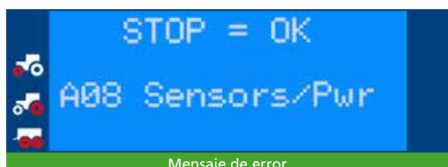
Para poder volver a utilizar el sistema de regulación de la presión de los neumáticos completamente tras subsanar el error, este se debe apagar y encender de nuevo. Para confirmar el error, se debe apagar y encender de nuevo el panel de control mediante el interruptor basculante.
