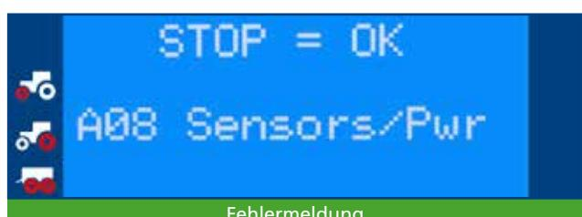
Um nach Behebung des Fehlers das Reifendruckregelsystem wieder vollständig zu benutzen muss aus-/eingeschaltet werden. Um den Fehler zu bestätigen muss die Bedienkonsole mittels Kippschalter aus-, und wieder eingeschaltet werden.
